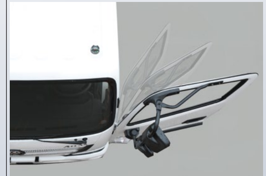
Kademeli olarak 90° açılabilen güçlendirilmiş yan kapılar
